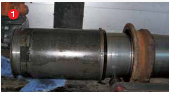
1 Kolben der alten 1-Säulenhebebühne wird demontiert
