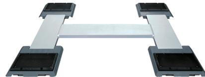
Diese Trägerbrücke garantiert eine schnelle, einfache und sichere Fahrzeugaufnahme und ist serienmäßig feuerverzinkt. Die niedrige Überfahrhöhe (59 mm) vereinfacht das Aufnehmen der Fahrzeuge und reduziert die Rüstzeit. Die Schieber sind von 1.400 bis 2.200 mm verstellbar.
