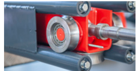
Stabile, geschweißte Säule und rollengelagerter Hubstuhl
