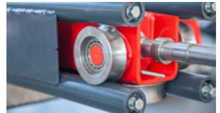
Stabile, geschweißte Säule und rollengelagerter Hubstuhl
