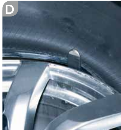
C-D. Bei Bedarf unterstützt das Werkzeug des unteren Arms diesen Vorgang bei besonders weichen Reifen.
