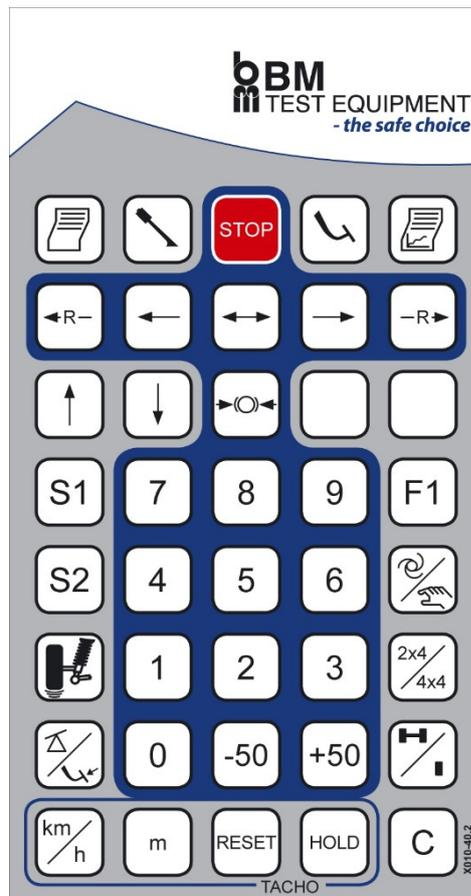
Tastaturbelegung der Infrarot-Fernbedienung.
