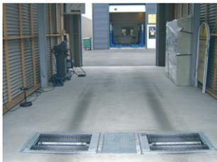
Der BM9010 ist ein Bremsprüfstand für leichte Fahrzeuge und Transporter mit Achslasten von bis zu 5000 kg und einer Standard- Spurprüfweite von min. 850 bis max. 2350 mm, bzw. bis 2850 mm optional.
