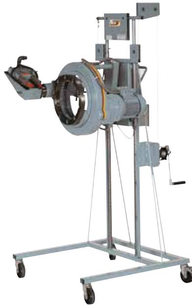
Maschine mit Wagen in Sonderhöhe bis 1500 mm zum Abdrehen von Brems­scheiben auf der Hebebühne.
