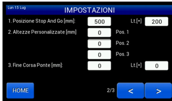
1. **STOP & GO-Position:** STOP & GO-Einstellung der Haupthebebühne konfigurierbar mit einer Höhe in mm im ersten Kästchen. Die STANDARD-Position befindet sich in einer Höhe von 500 mm über dem Boden. Im zweiten weißen Kästchen können Sie den STOP & GO der Hilfshebebühne einstellen (NB: der Wert für die Hilfshebebühne ist nicht in mm angegeben, sondern es ist ein Wert, der auf den Neigungsmessern basiert).
